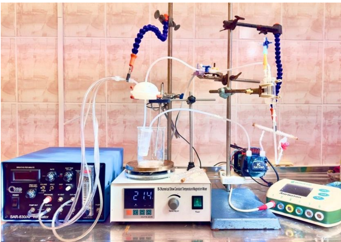
Рисунок 12 – Стенд для проведения нормотермической машинной перфузии донорских легких крыс, общий вид
