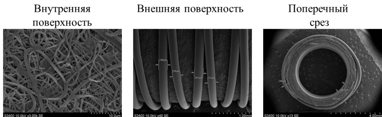
Рисунок 48 – Сканирующая электронная микроскопия сосудистых протезов ПКЛ/ПВП/Ил/А диаметром 4 мм
