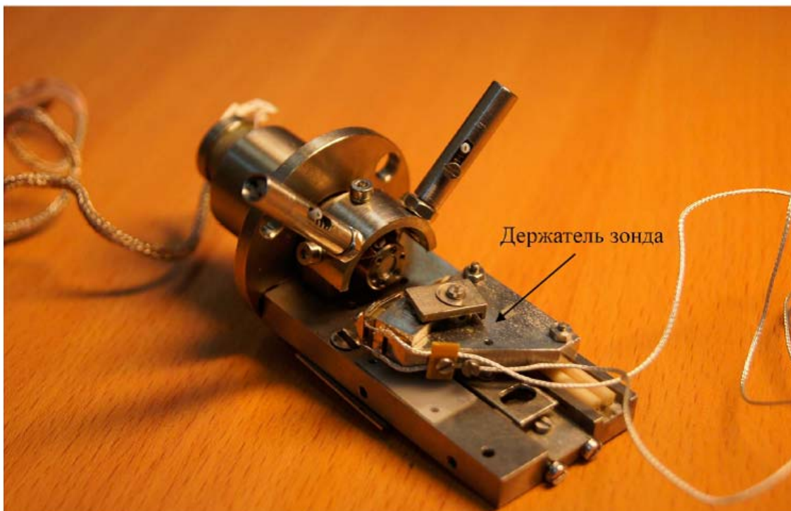
Рисунок 8 - Внешний вид системы сканирования с установленным держателем зонда
