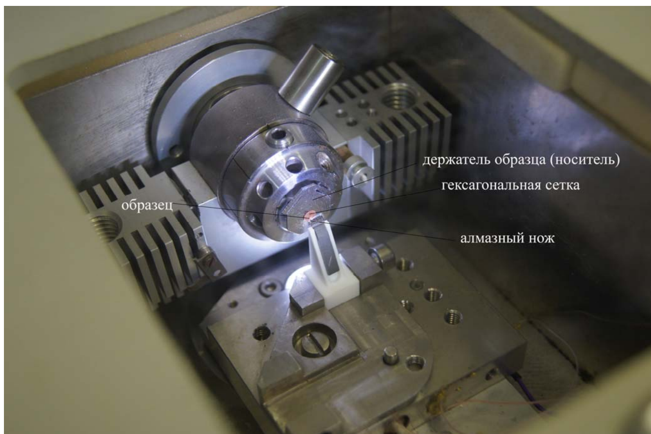
Рисунок 22 - Выполнение срезов суспензии альгинатных гидрогелевых микроносителей алмазным ножом Diatome CryoAFM 35 при температуре минус 120 °С в криокамере ультрамикротом
