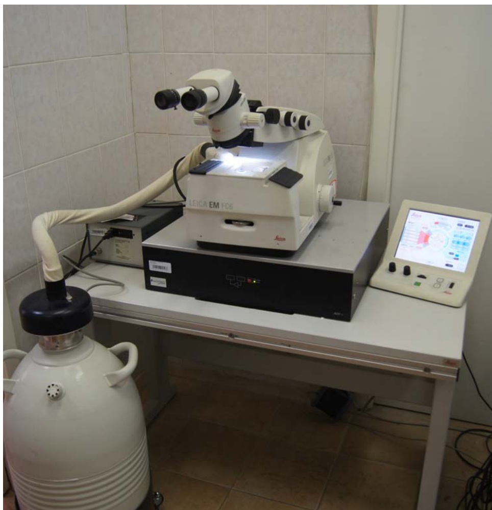
Рисунок 21 - Криоультрамикротом Leica EM UC6/FC6 (Leica Microsystems, Австрия) используемый для выполнения срезов образцов суспензии альгинатных гидрогелевых микроносителей при низких температурах
